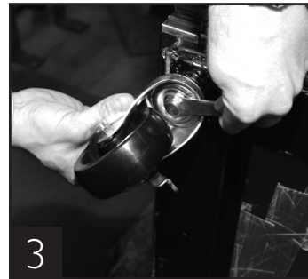
3 Utilisez l'outil fourni pour serrez la roulette à sa place.
