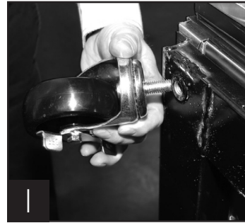
1 Enfonchez la roulette sur le dessous du rail du cadre du bac.
