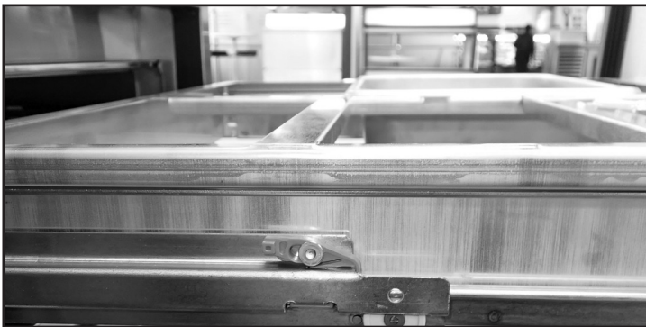
Fig. 1. Emplacement du taquet de retenue de tiroir. Le taquet est engagé.
