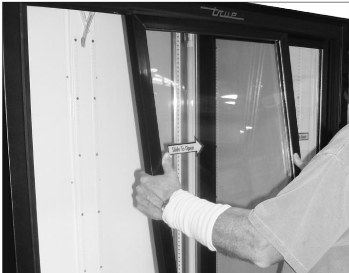
Fig. 4. Déposez la porte avec précaution.
