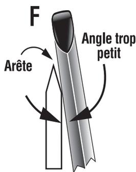
Le fusil repose sur l'embase. L'arête n'est pas aiguisée.
