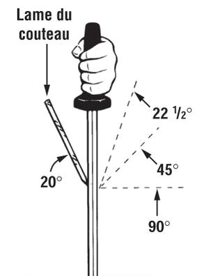
Une méthode simple pour calculer le degré de l'angle. Débutez avec un angle d'environ 20°.
