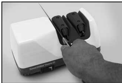
Figura 3. Fase 1. Inserimento della lama nello spazio compreso fra la guida e la molla in elastomero. Alternare singoli passaggi nello spazio destro e sinistro.
