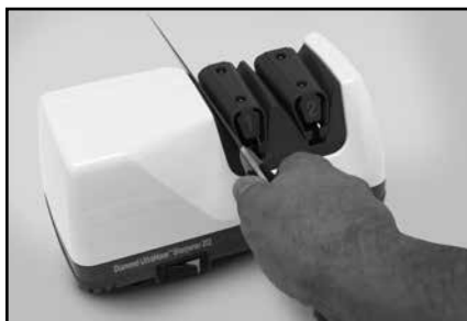
Figura 3. Etapa 1. Inserción de la cuchilla en la ranura entre la guía y el muelle elastomérico. Pasadas individuales alternadas en la ranura izquierda y derecha.
