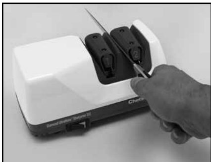
Figura 6. Inserimento della lama nello spazio sinistro di fase 2. Alternare singoli passaggi nello spazio destro e sinistro.
