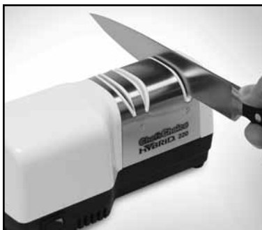
Figura 4. Coltello nel Passaggio 2. Fare passate per affilare avanti e indietro con una leggera pressione verso il basso. Fare riferimento al testo.
