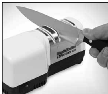
Figura 3. Inserimento della lama nella guida destra del Passaggio 1. Alternare passate nelle guide di sinistra e di destra.
