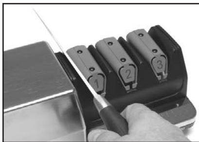
Abbildung 5: Stufe 1. Einführen der Klinge in den Schlitz zwischen Führung und Haltefeder. Abwechselnd durch den linken und den rechten Schlitz ziehen.
