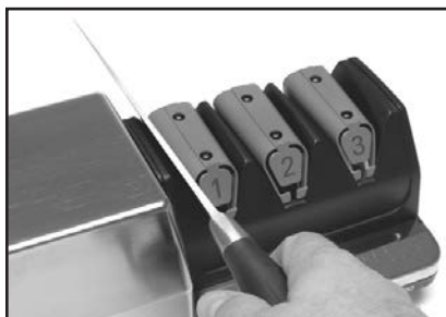
Afbelding 5: Fase 1. Voer de snede in de sleuf in tussen de geleider en het veermechanisme om het mes naar beneden te houden. Gebruik afwisselend de linker- en rechtersleuf.
