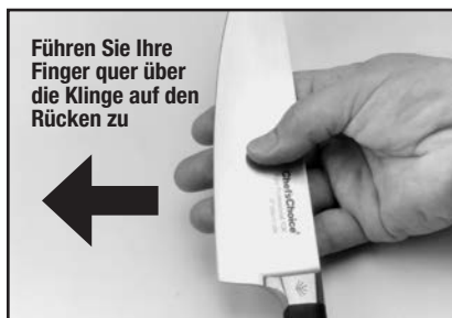
Abbildung 7: Sie fühlen den Grat, wenn Sie den Finger quer über die Klinge auf den Rücken zu führen. Vorsicht! Siehe Text.
