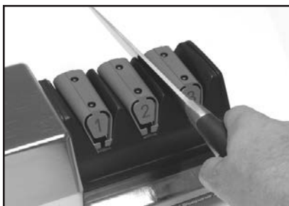
Afbeelding 10: Invoer van de snede in de linkersleuf van Fase 3. Wissel af tussen de linker- en rechtersleuf.
