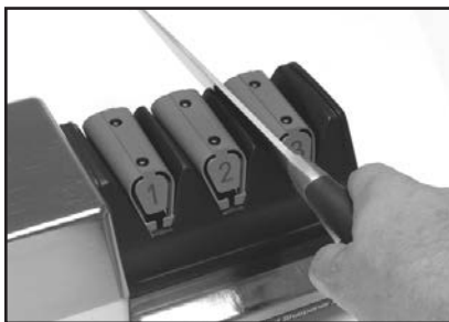
Abbildung 10: Einführen der Klinge in den linken Schlitz von Stufe 3. Abwechselnd durch den linken und den rechten Schlitz ziehen.
