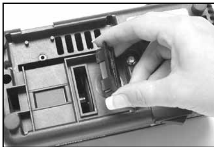
Figura 18. Togliere il coperchio sotto la base per rimuovere la polvere metallica (consultare la sezione manutenzione ordinaria).
