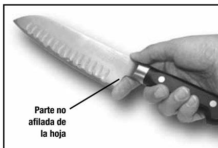
Figura 16. Si la hoja posee una parte sin filo considerable, puede serle útil colocar el dedo detrás, tal como se muestra, al realizar la operación de afilado.
