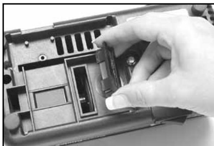
Figure 18. Enlevez le couvercle sous le socle afin de retirer les poussières métalliques (Voir le chapitre Entretien normal).
