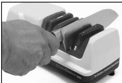
Figura 10. Affilatura sulla coramella/lucidatura di moderni coltelli asiatici nella fase 3.
